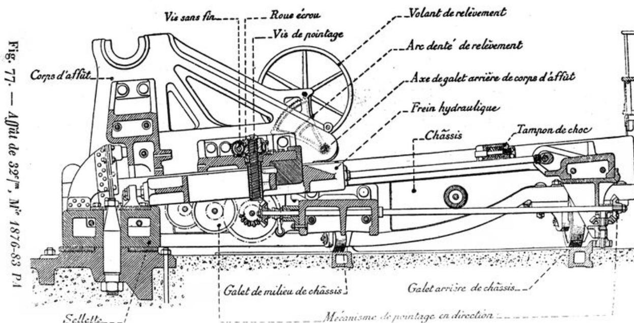
Plan détaillé d'un affût modèle 1876-1883 PA pour canon de 32 cm (armement de la batterie extérieure du Portzic)
