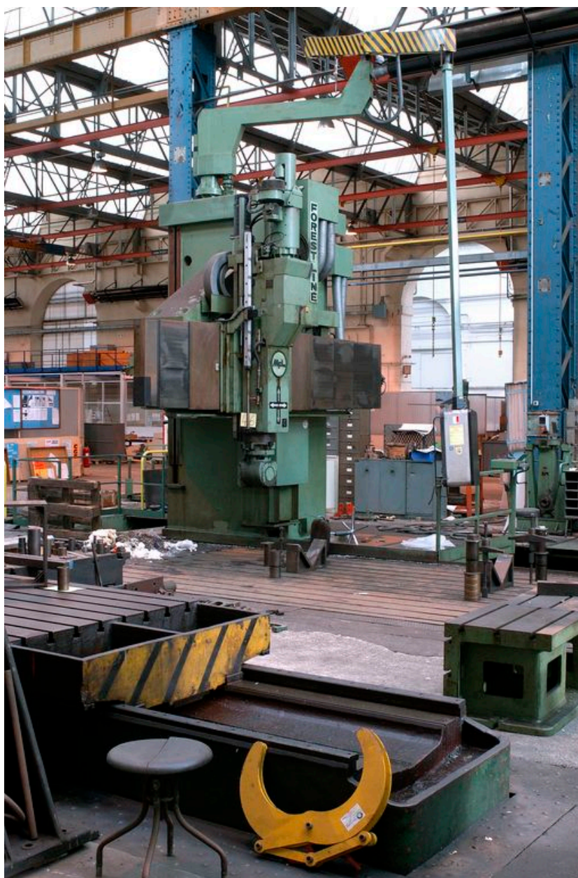
Vue de la halle d'usinage : fraiseuse lourde à montant mobile forest-line (1984)
