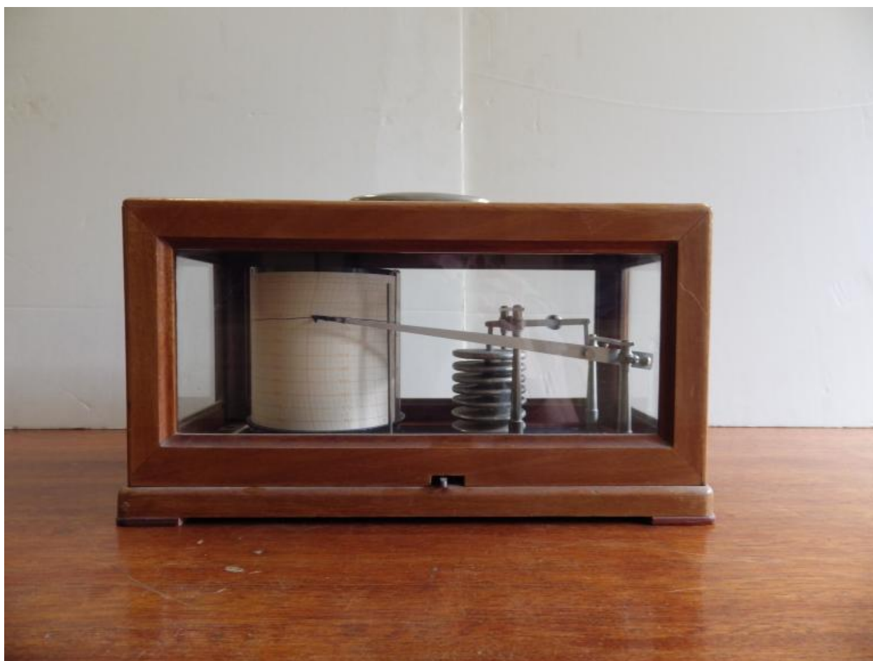
Baromètre enregistreur - Propriétés des gaz (Anc. Ets. L. Maxant)
