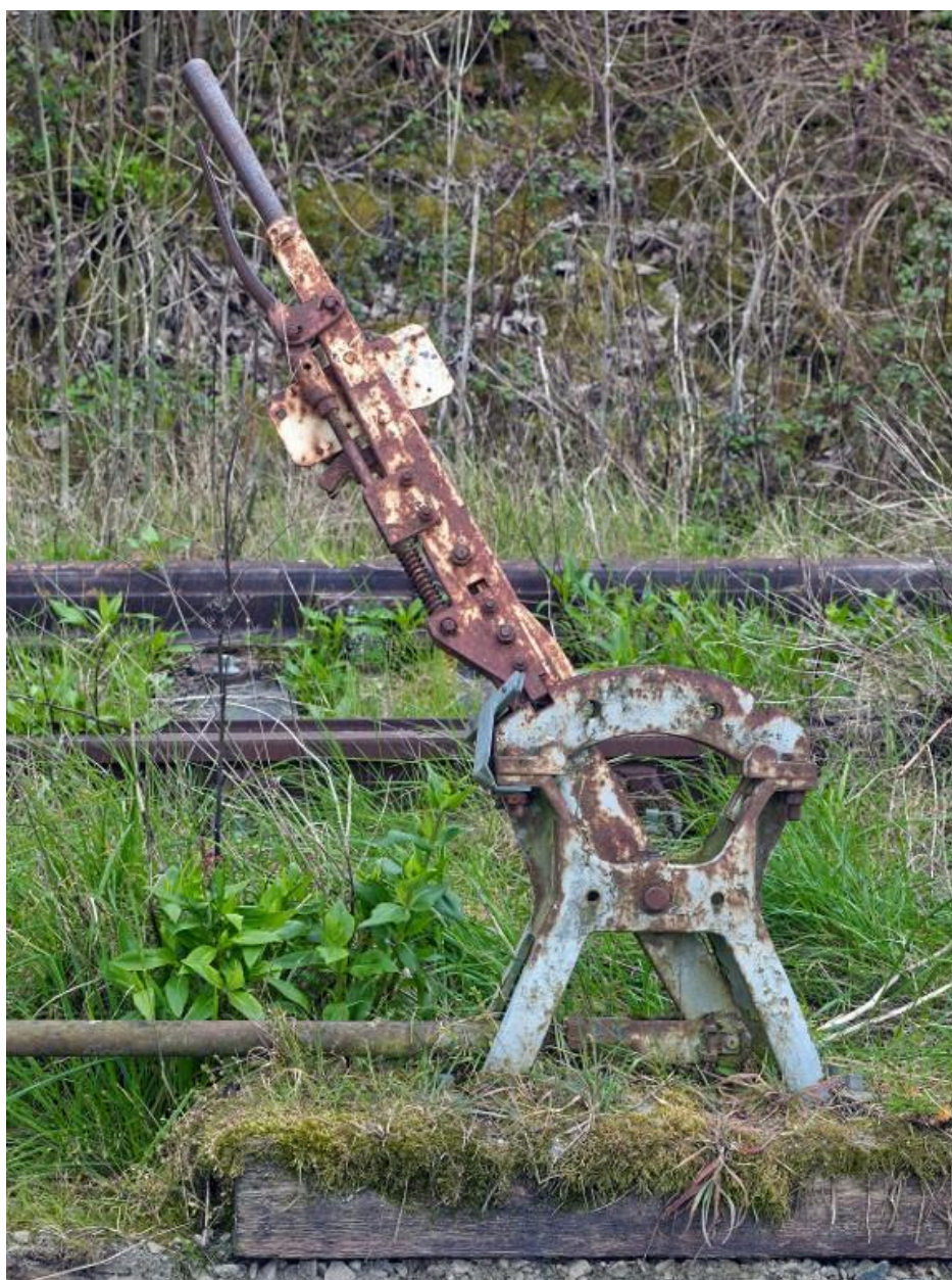
Matériel ferroviaire au port : l'aiguillage
