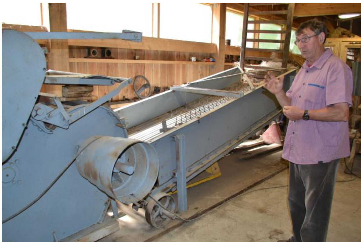
Teilleuse à étoupe du teillage mécanique - 4ème étape
