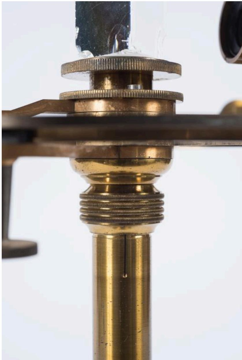
Détail de la plate-forme du goniomètre de Babinet sur laquelle est placé un prisme
