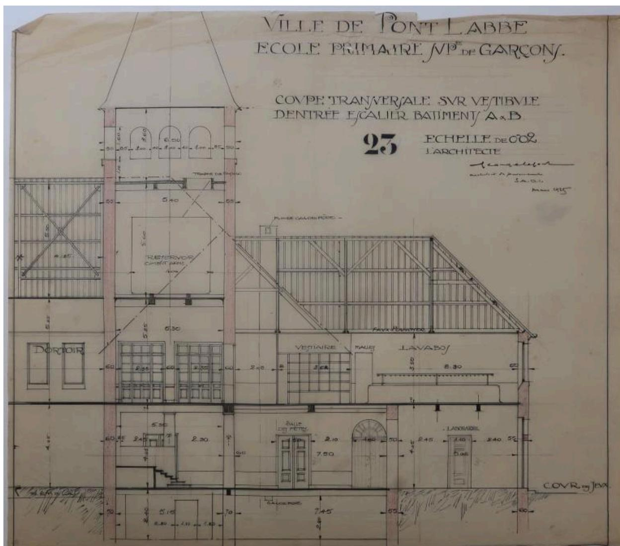
Coupe transversale sur le vestibule d'entrée. G-R. Lefort, architecte, mars 1925. Noter la présence, dans le campanile, d'un réservoir d'eau en ciment armé.
