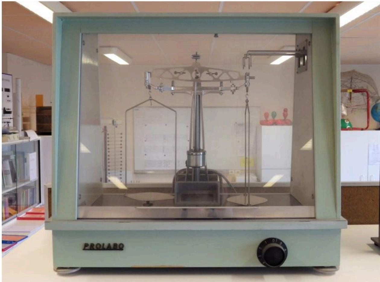
Balance de précision - Pesanteur-Mécanique-Mesure (Prolabo, 1950-1975)
