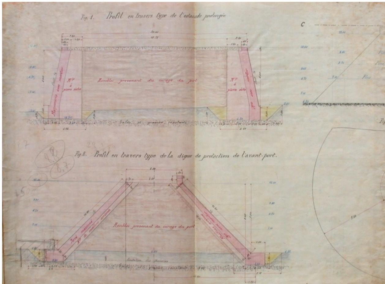
Plan daté de 1894 : profil en travers de l'estacade et de la digue de protection de l'avant-port (AD 22)
