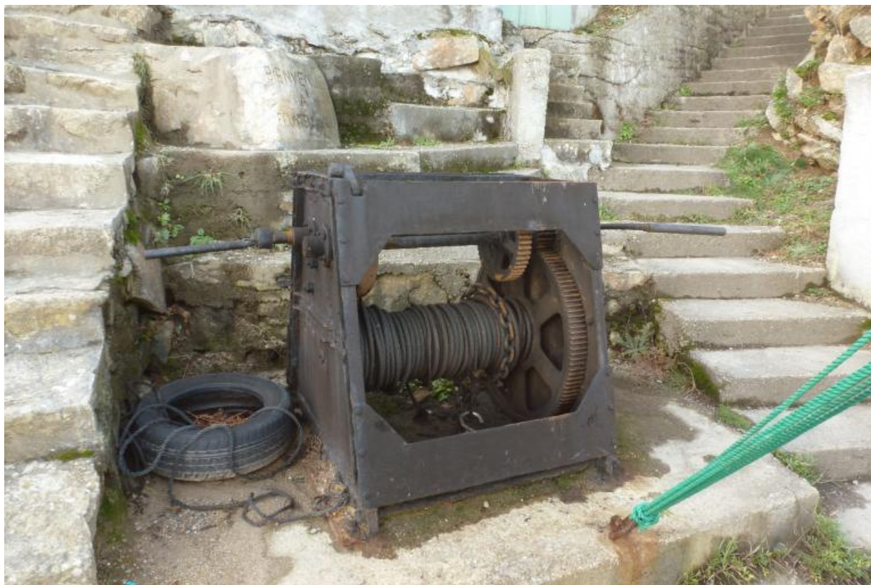
Détail du treuil de hissage.
