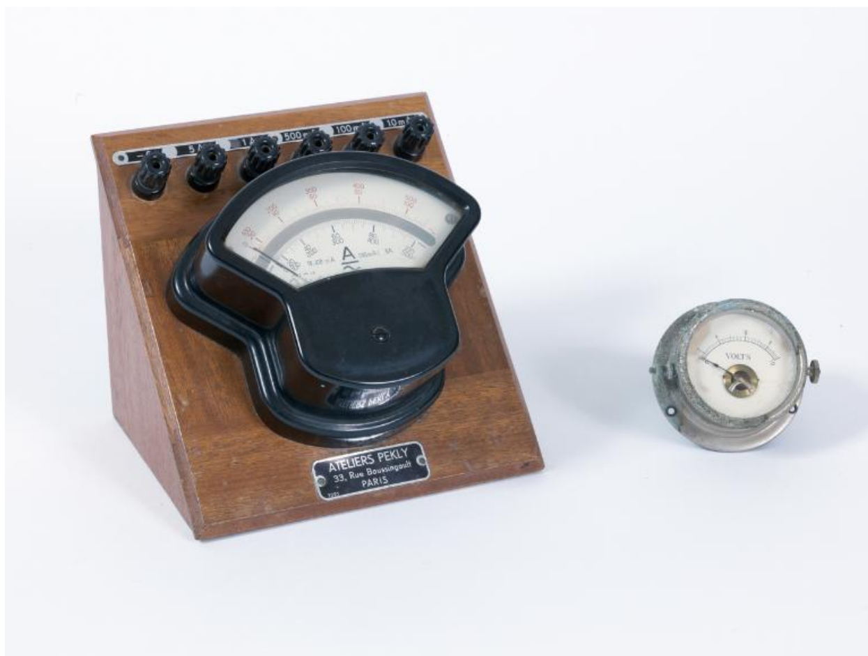
Ampèremètre et voltemètre de poche - Electricité dynamique (Ateliers Pekly)
