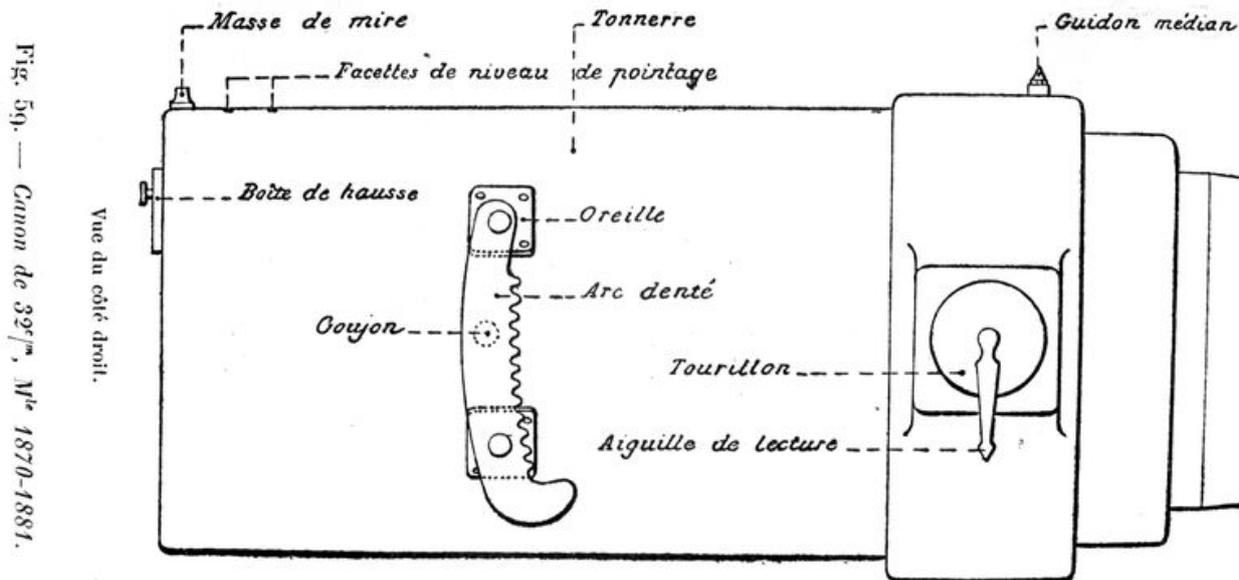
Fig. 59. — Canon de 32<sup>m</sup>, M<sup>e</sup> 1870-1881.
