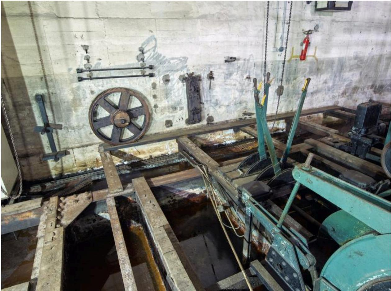
Vue des pièces de rechange et outils fixés au mur : roue dentée, clés et cric manuel. A droite, les leviers des commandes mécaniques du treuil
