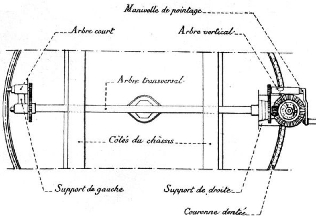
Plan détaillé du mécanisme de pointage en direction de l'affût modèle 1888 pour canon de 274 mm
