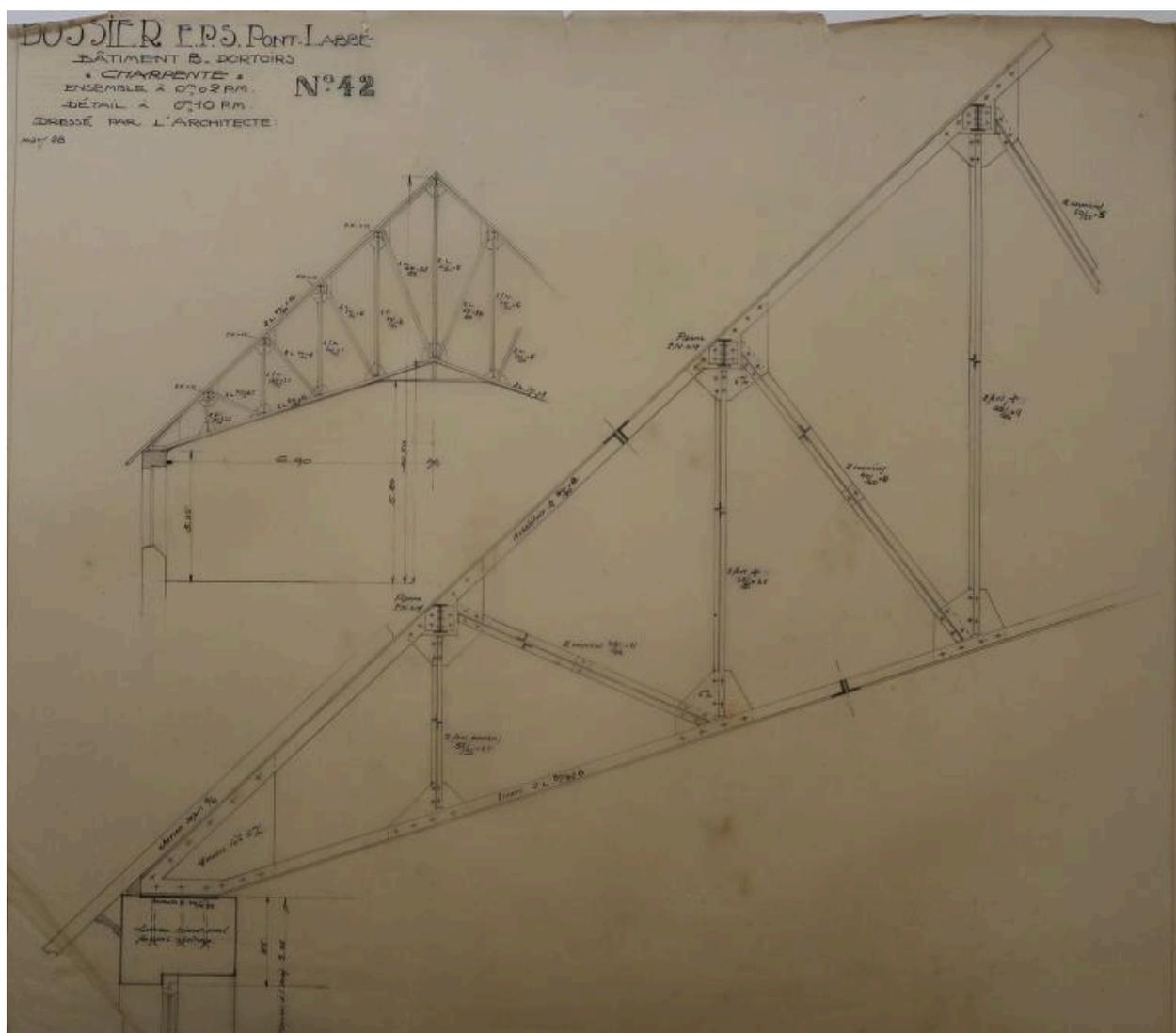
Charpente. G-R. Lefort, architecte, mars 1928. La charpente des dortoirs (aile nord) est métallique.
