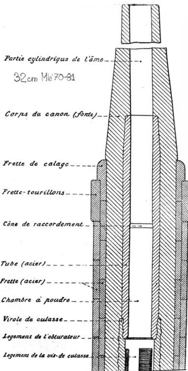
Coupe d'un canon de 32 cm modèle 1870-1881 (armement de la plupart des batteries de la rade de Brest sur affûts M modèle 1882 PA)
