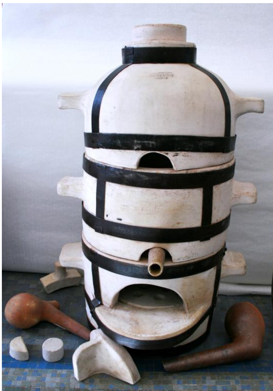
Fourneau à réverbère démontable - Chimie (Poulenc Frères)
