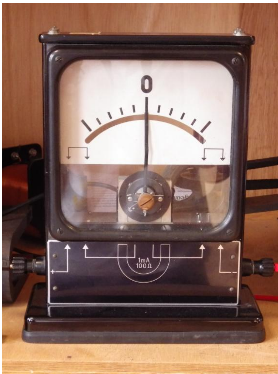
Ampèremètre à cadran interchangeable - Electricité dynamique (A.O.I.P., deuxième moitié du 20e siècle)
