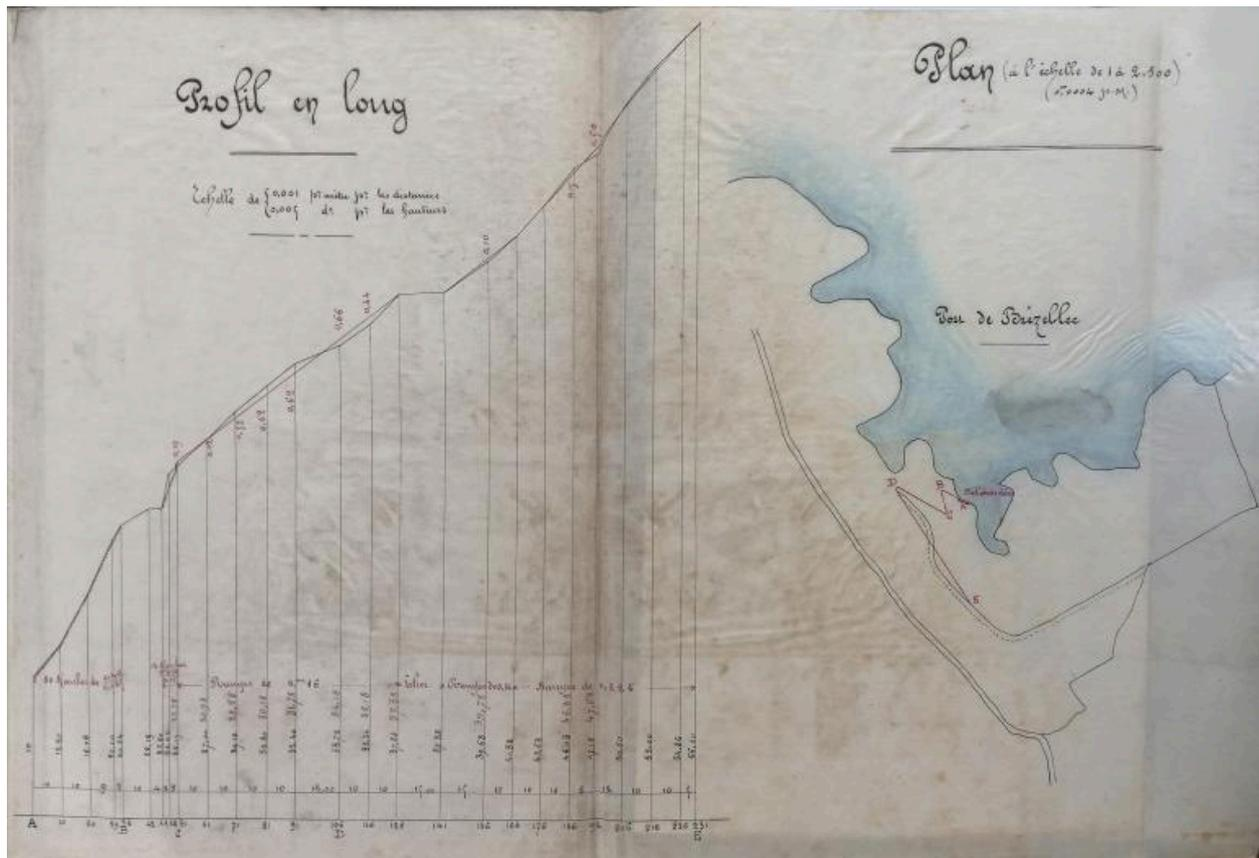
Voie d'accès au débarcadère de Brezellec, plan et profils. Reproduction plan des Ponts et Chaussées, 1888.
