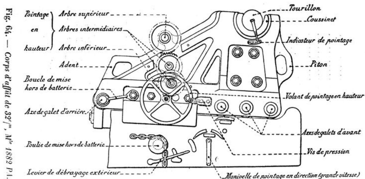
Plan détaillé du corps de l'affût modèle 1882 PA pour canon de 32 cm
