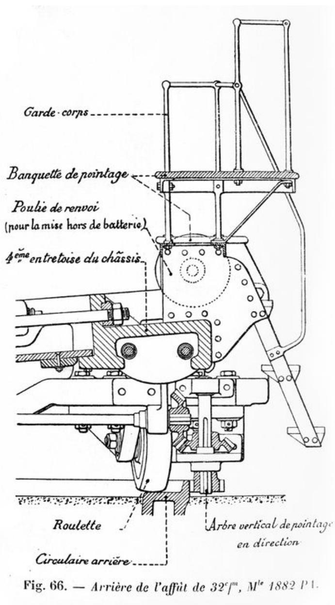
Plan détaillé de l'arrière de l'affût modèle 1882 PA pour canon de 32 cm
