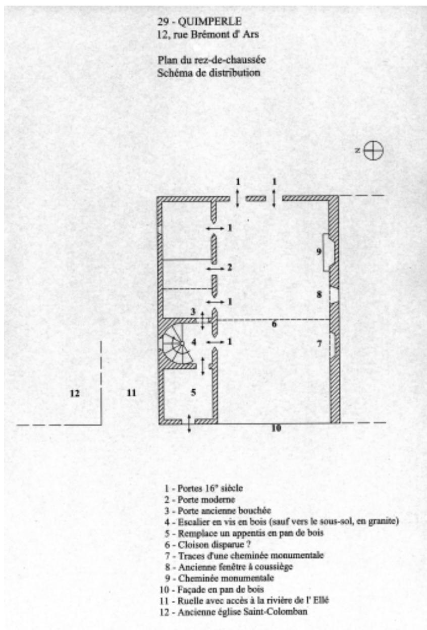
Rez-de-chaussée, schéma de distribution
